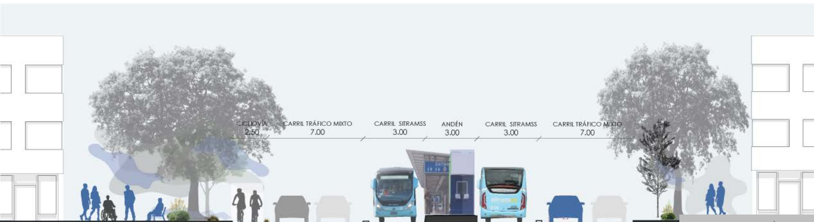
secciones típicas de los corredores BRT
