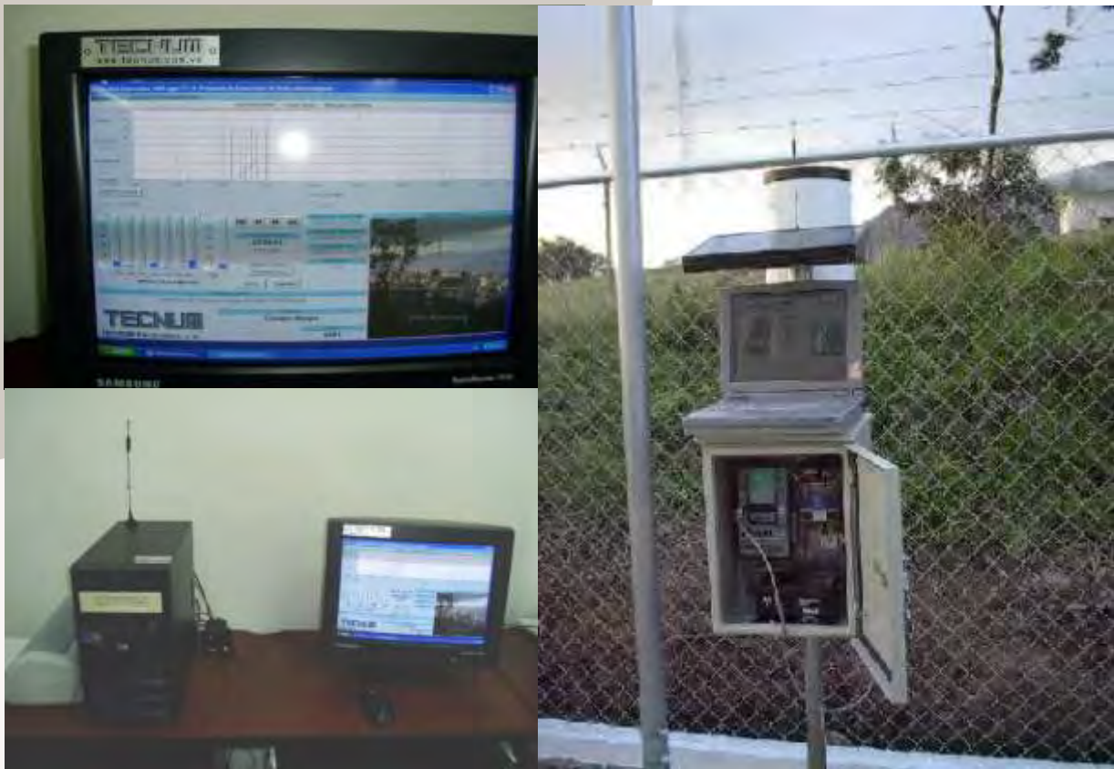
Figura 32. Fotos del tipo de tecnología tipo que soporta las experiencias piloto SAT opera mantiene el Departamento de Hidrometeorología de la Universidad Central de Venezuela. Fuente: PREDERES, 2004
