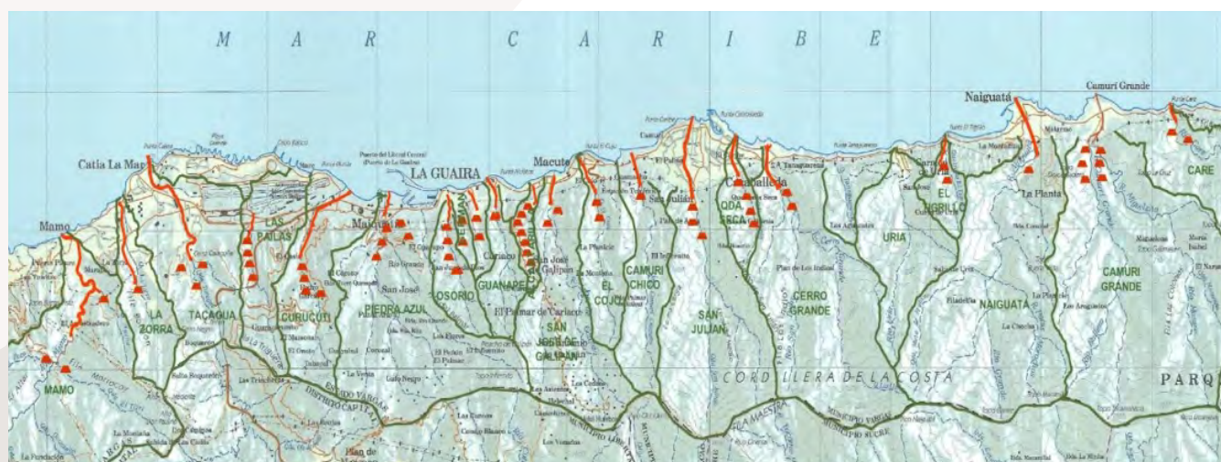
Figura 27. Mapa de ubicación de las presas construidas para el control de sedimentos en las cuencas del estado Vargas. Fuente: López, 2012.
