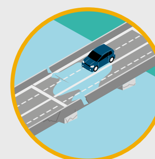
3 Erosión de márgenes y apoyos
