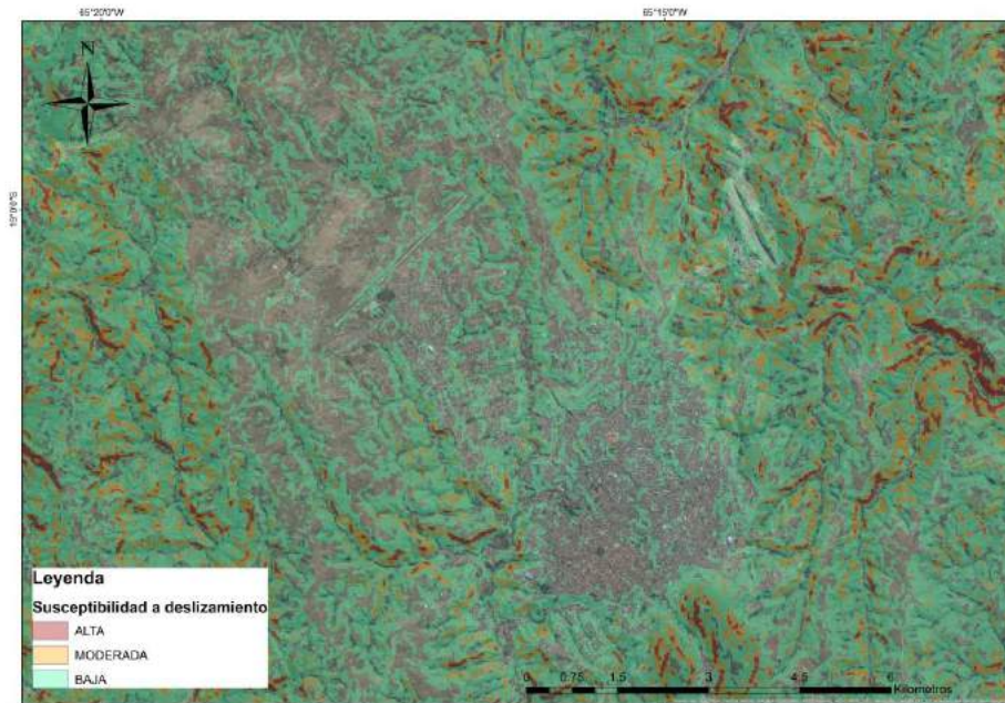
Figura 58. Resultados típicos de análisis de susceptibilidad a los deslizamientos condición 2, ciudad de Sucre. Fuente: Imagen satelital obtenida de Google Earth 7.1
