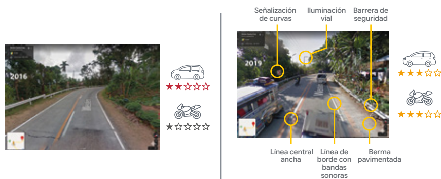
Figura 39. Mejora de la seguridad vial para motocicletas y similares mediante contramedidas de iRAP en Filipinas
