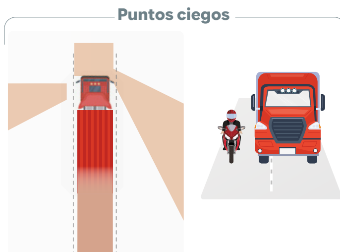
Figura 35. Áreas de puntos ciegos alrededor de vehículos de gran tamaño
