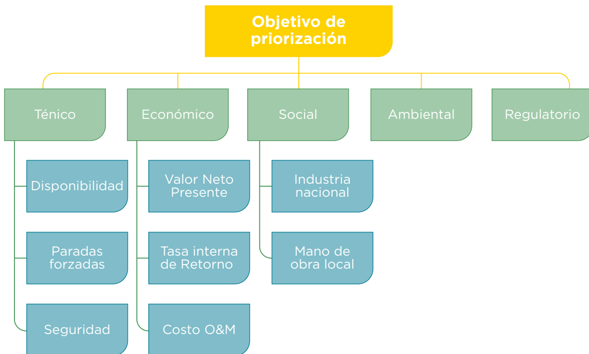
FIGURA 3. Ejemplo de estructura de criterios y subcriterios para la priorización de potenciales centrales hidroeléctricas sujetas a modernización
