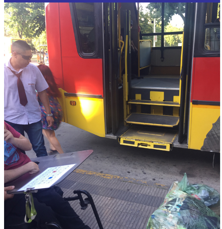
FIGURA 9. CONDUCTOR DEL AUTOBÚS TRATA DE BAJAR LA RAMPA, PERO ESTA NO FUNCIONA
