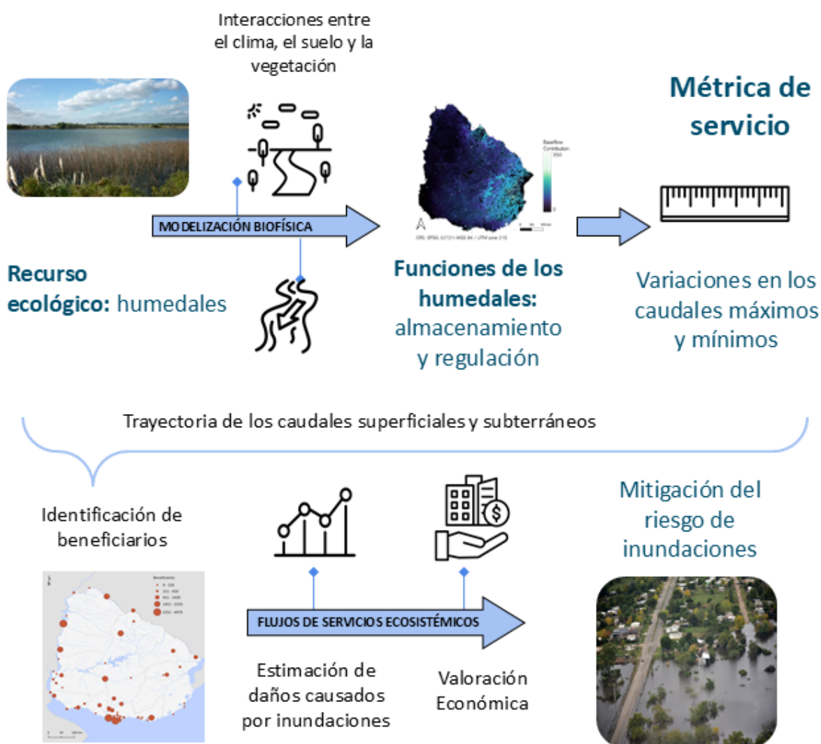
Figura 4. Cadena lógica de la valoración de los servicios ecosistémicos. Ejemplo de flujo de trabajo para la modelización biofísica y la valoración económica de los servicios ecosistémicos aplicado a los servicios de mitigación de inundaciones y utilizando el modelo InVEST Seasonal Water Yield.
