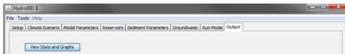
Figura 3-4. Ficha de Salida (Output) en el Modelo Central de Hydro-BID
