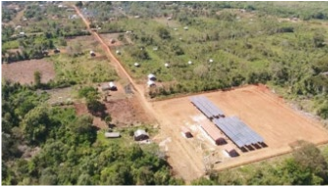
Desmonte de vegetación en una planta solar híbrida, (Solar - Diésel) con una potencia instalada de 168 KW pico, en Bolivia. Fuente: INEL, Proyecto El Remanso, Bolivia.
