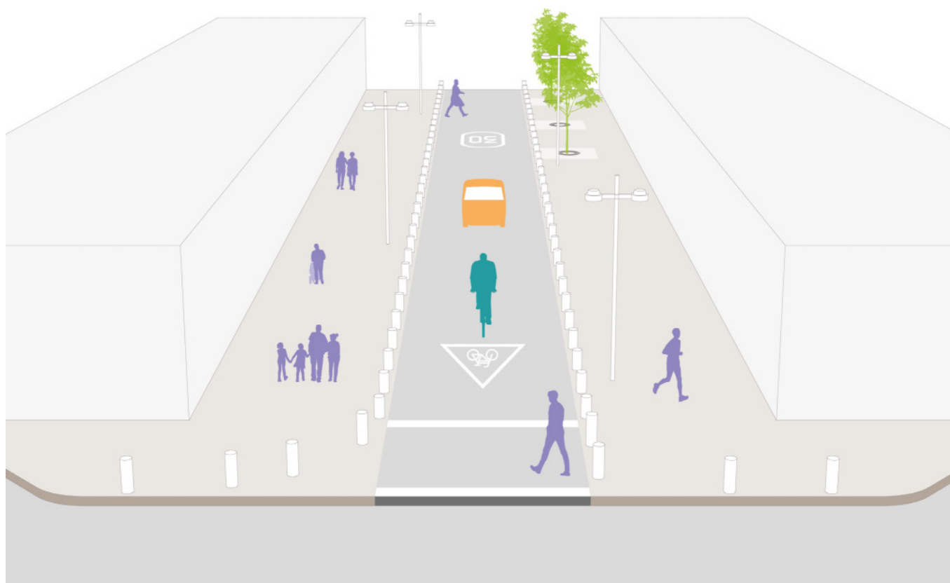
Figura 48. Sección de una calle para Zona 30 en el Centro Histórico. Fuente: elaboración propia.
