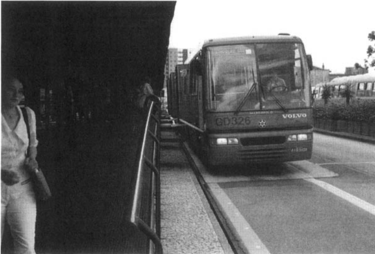
Figura 1. Se accede a los autobuses a nivel por medio de "puentes" formados al bajar sus placas (montadas al lado externo de las puertas) hasta apoyarse en las placas salientes de la plataforma. En esta foto, el embarque/desembarque ha concluido, las puertas están cerrándose y la primera placa está levantándose. (fotos de Charles L. Wright)
