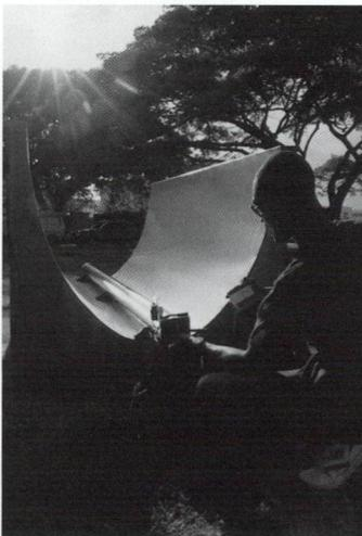
*El panel de absorción de una secadora solar.*
