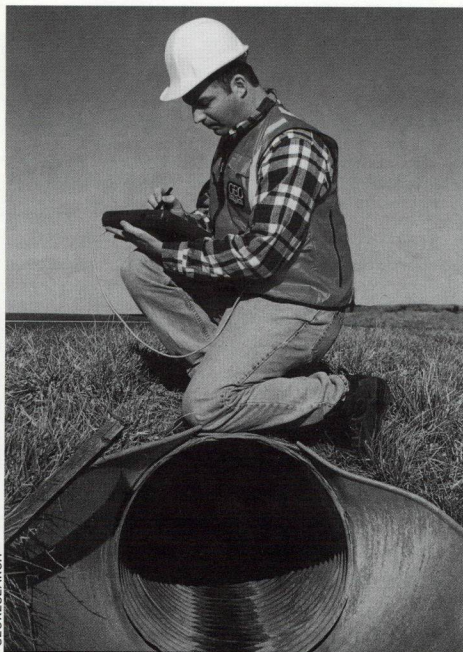
Un técnico equipado con un receptor de GPS registra la ubicación de una boca de tormenta mediante un sistema de trazado de mapas creado por GeoResearch, Inc. Esta técnica es usada para crear mapas digitales y bancos de datos.
