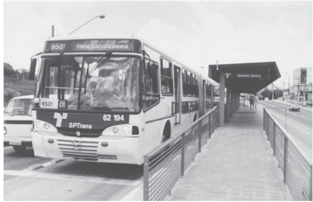
Foto 31. Autobuses con puerta del lado izquierdo, en São Paulo. Exigen paradas construidas especialmente para esa característica.
