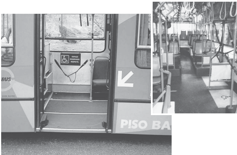
Fotos 28 y 29. Autobús de piso bajo. El de Belo Horizonte no tiene obstáculos internos y la diferencia de nivel para el acceso es sólo de 30 cm. El de Buenos Aires (a la derecha) no tiene desniveles internos y la última puerta tiene un escalón interno de 15 cm.
