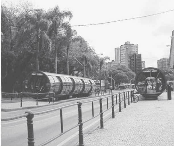
Foto 11. Estación-tubo de Curitiba. Vehículos dotados de plataformas-puente para embarque y desembarque de pasajeros a nivel.
