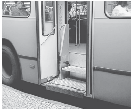
Foto 32. Autobús con elevador para personas con discapacidades físicas en Belo Horizonte. El lento mecanismo del elevador retarda el viaje.
