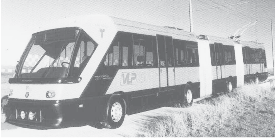
Foto 14. El “acaba fila” de São Paulo. Trolebús biarticulado con puerta de los dos lados para circular en vías diferenciadas.
