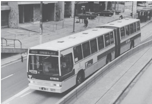
Foto 13. Autobús articulado saliendo de una parada en el carril exclusivo en São Paulo. En el corredor Itapequerica de la Serra, los autobuses hacen un desvío a la izquierda para tener acceso a las paradas en el sector central y después vuelven a circular a la derecha de ese carril.
