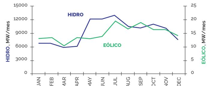
Figura 5. Comparación del régimen eólico e hídrico en el sistema eléctrico sur-este de Brasil. Tomado de (Schultz, 2005)
