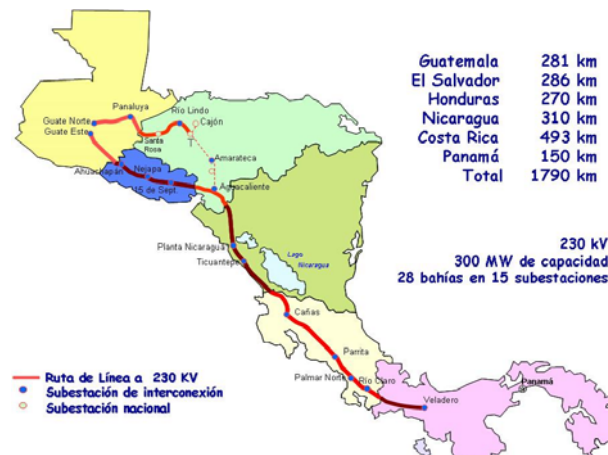
Gráfico 12.12 Sistema de Transmisión Eléctrica Regional en construcción
