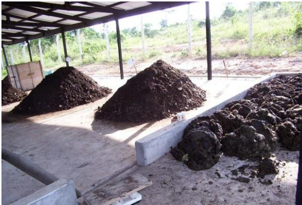
Compostaje aeróbico de lodos biológicos.
